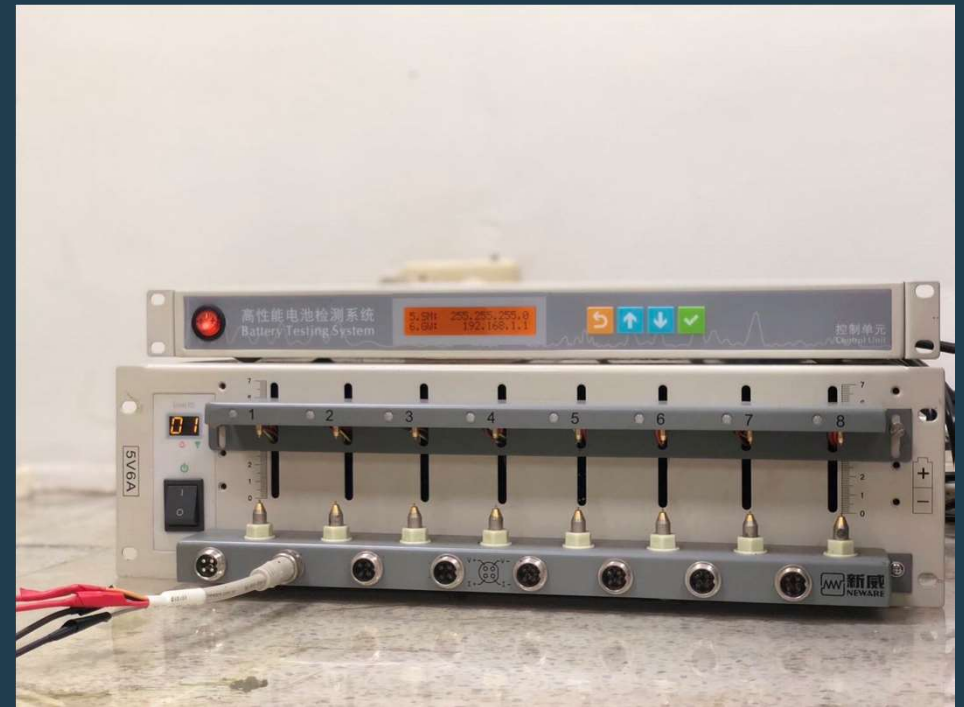
電池性能檢測系統
